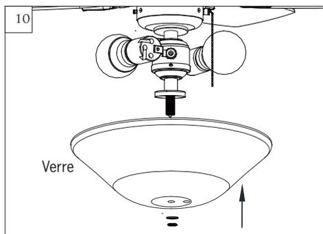
Soulevez le verre afin de guider les chaînettes à travers les orifices appropriés dans le verre, en alignant la tige filetée sur le luminaire avec l'orifice au centre du verre et en poussant vers le haut doucement pour permettre à la tige filetée de passer à travers l'orifice. (**Remarque:** Assurez-vous que la chaînette pour faire fonctionner le ventilateur ne frotte pas contre l'ampoule lors d'une utilisation).
