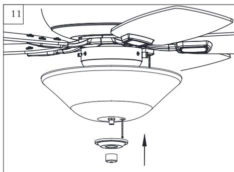
Alignez l'orifice au centre du capuchon du faîteau avec la tige filetée, permettant aux chaînettes de passer à travers les orifices appropriés dans le faîteau final, et pousser vers le haut. Faites passer la chaînette du centre à travers l'orifice dans le faîteau et fixez le verre au luminaire en serrant le faîteau. **NE SERREZ PAS TROP** le faîteau car le verre peut fendre ou se briser.
